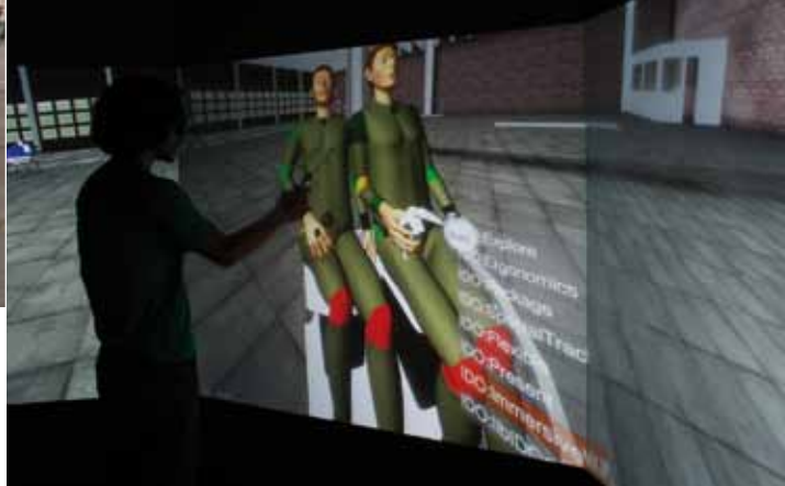
Ergonomische Studie in der dritten Dimension: Die Forschenden testen, welche Sitzposition für den virtuellen Fahrer am komfortabelsten ist.
