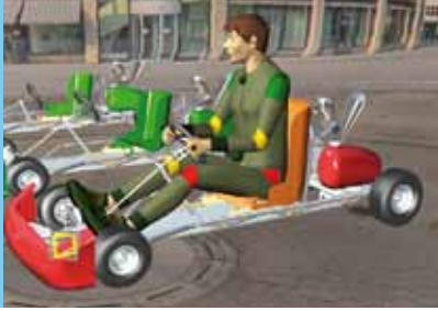
Ergonomische Studie in der dritten Dimension: Die Forschenden testen, welche Sitzposition für den virtuellen Fahrer am komfortabelsten ist.
